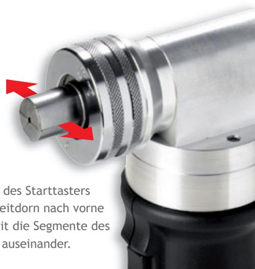
Bei Betätigung des Starttasters fährt der Aufweitdorn nach vorne und treibt somit die Segmente des Aufweitzkopfes auseinander.
